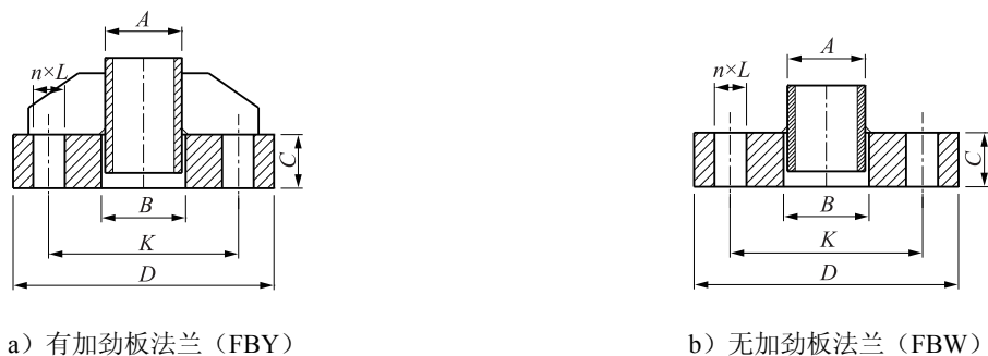
图 A.2 钢管塔用板式平面法兰连接的有加固板法兰和无加固板法兰
